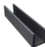
DF4U40 Profilé en U pour clôture latte 4 x 5,5 x 202 cm (pour tenir les planches et comme profil de finition en haut de la dernière planche)
